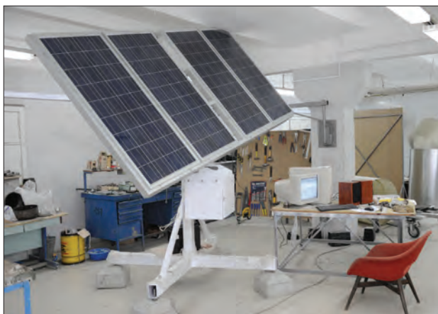
Figura 21. Asamblarea sistemelor de conversie a energiei solare, CITA Etalon, UTM
