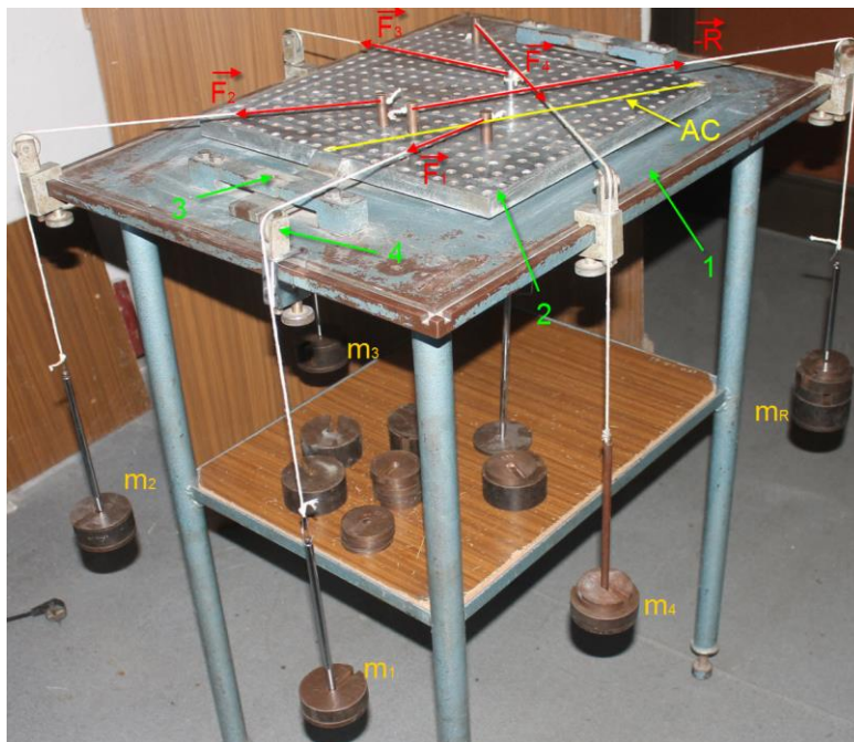
Figura 1: Dispozitivul experimental (1 – masă, 2 – placă cu alezaje, 3 – element de fixare, 4 - scripete)
