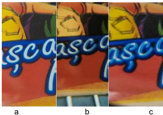
Figura 8: Clișeul de Reflex Blue deplasat progresiv pe lungimea de tipar: a – prima repetiție; b – a doua repetiție; c – a treia repetiție.
