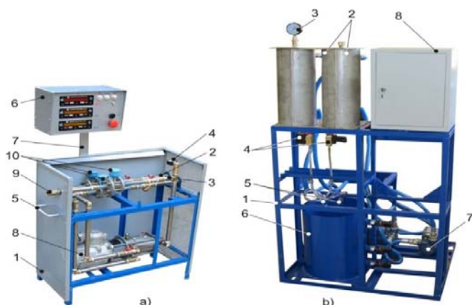
Figura 3. Vederea generală a instalațiilor „Biomixt” (a) și „Biomixt-Pres”(b).
