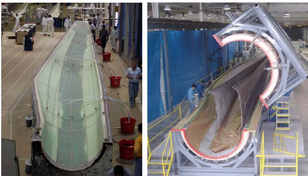
Figura 3. Tehnologia de fabricare a palelor
