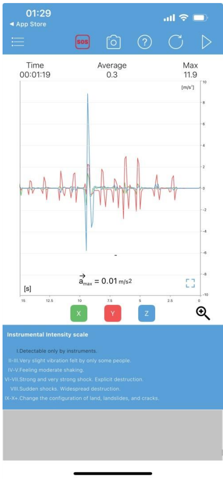
Figura 13. Captură de ecran a interfeței aplicației Vibrometer: Seismograph cu prezentarea rezultatelor măsurării vibrațiilor.
