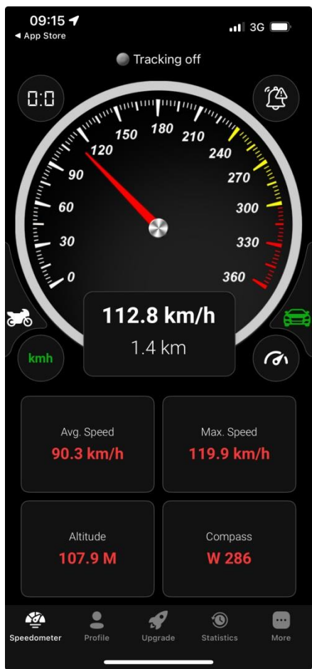
Figura 11. Captură de ecran a interfeței aplicației Speedometer în timpul măsurării vitezei de deplasare a autovehiculului.
