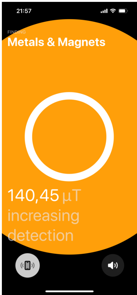
Figura 16. Captură de ecran a interfeței aplicației Magnetometer, prezentând rezultatele măsurării câmpului magnetic din imediata apropiere a telefonului mobil.
