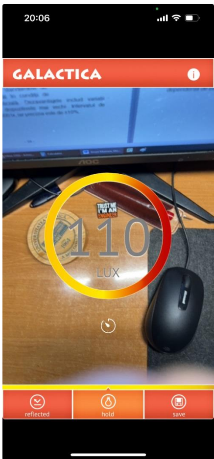
Figura 9. Captură de ecran a interfeței aplicației Galactica Luxmeter cu rezultatele măsurării iluminării (luminanței) la locul de muncă/birou, la înălțimea ochiului utilizatorului.
