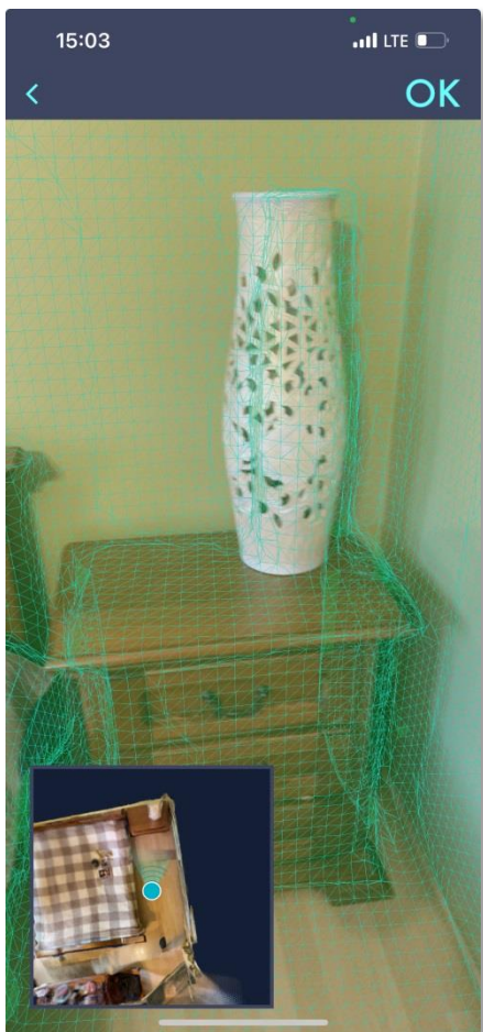
Figura 4. Captură de ecran a interfeței CamToPlan în procesul de scanare a obiectelor în vederea determinării volumului acestora.
