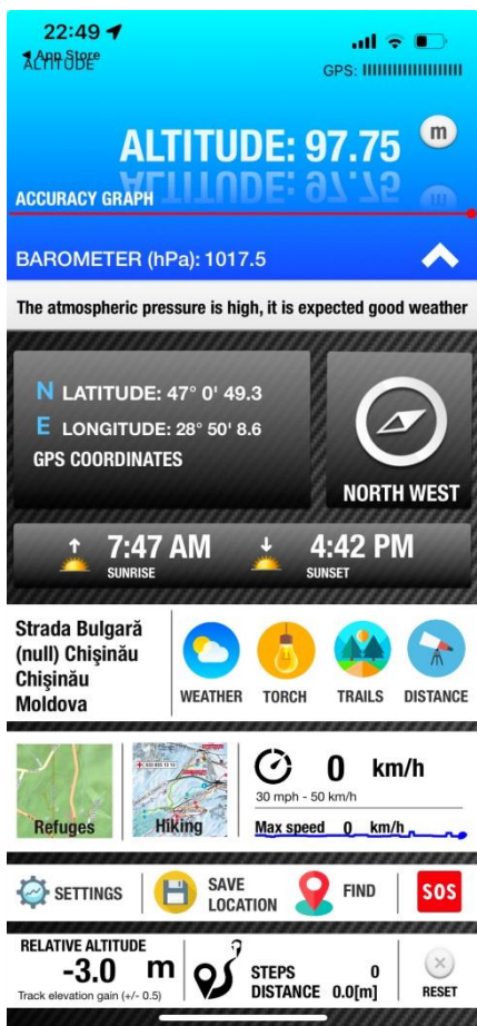
Figura 5. Captură de ecran a interfeței Altimeter GPS Pro cu rezultatele măsurării altitudinii, precum și a altor mărimi (coordonatele poziționării geografice, presiunea atmosferică, umiditatea etc.).
