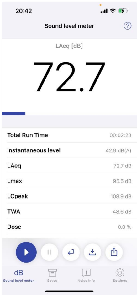
Figura 14. Captură de ecran a interfeței aplicației Niosh Sound Level Meter, prezentând rezultatele măsurării intensității sonore pe un interval de 2:23 minute.
