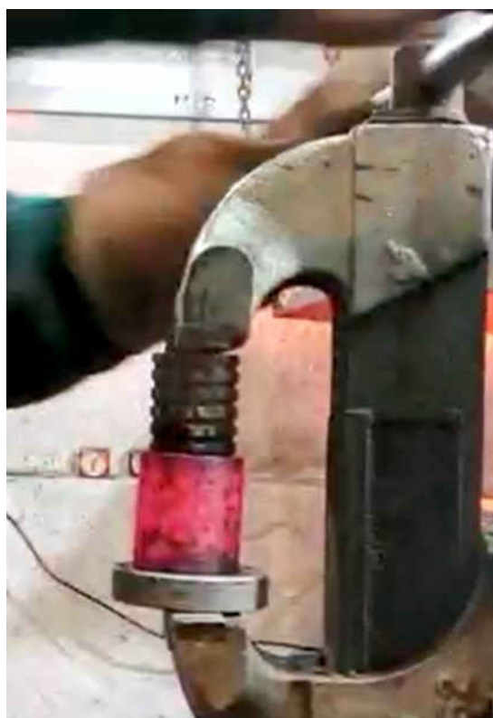
Asamblarea piesei de lucru al încălzitorului
