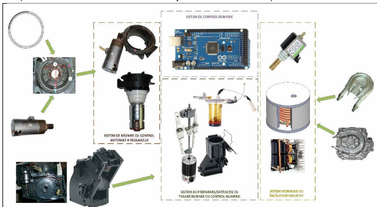
Fig. 2.34. Diagrama structurală a sistemului electromecanic al aparatului de cafea inovațional cu încălzitor inductiv [elaborat de autor]
