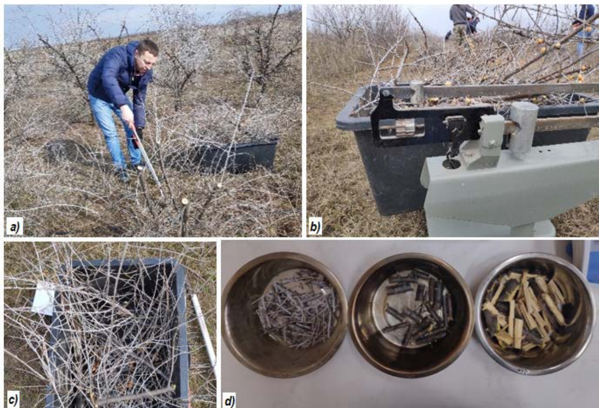
Figura 2. Secvențe referitoare la pregătirea probelor pentru încercări: a) emondarea pomilor; b) cântărirea probelor în câmp; c) probe mărunțite grosier în câmp; d) probe pregătite în laborator: de la stânga la dreapta – de un an, de 2–3 ani, mai bătrâne de 3 ani.
