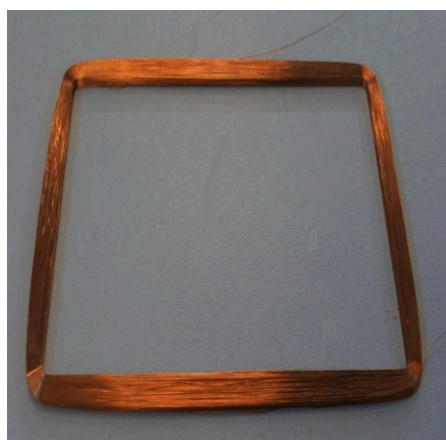
Figura 4.84. Mostră de prototipare de magnetorcher.
