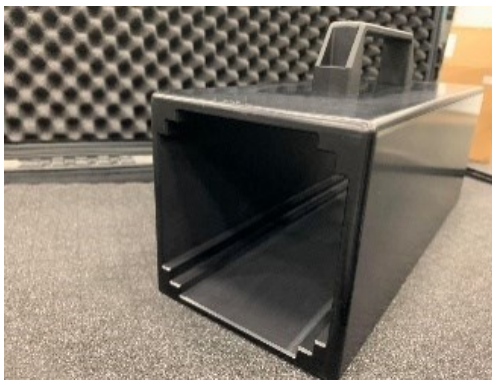
Figura 5.5. Modelul pentru confirmarea potrivirii satelitului cu lansatorul JSSOD
