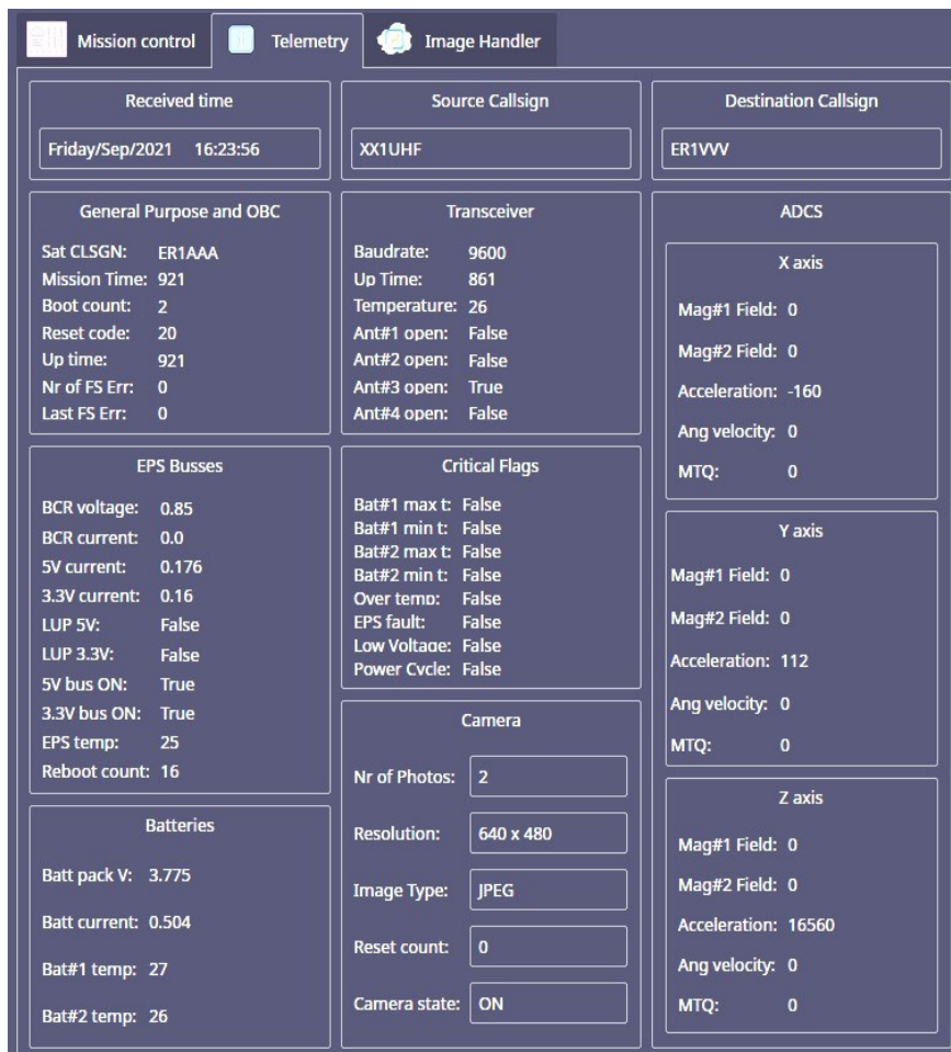
Figura 6.11. Exemplu de reprezentare a informației dintr-un mesaj tip baliză recepționat de la nanosatelitul TUMnanoSAT.
