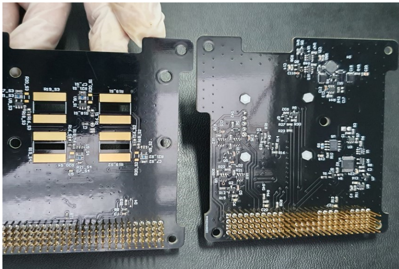
Figura 4.113. Modulul final de testare a nanosenzorilor: vedere de sus și de jos.
