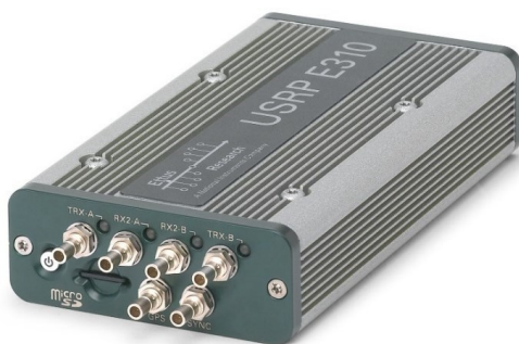
Figura 6.3. Dispozitivul hardware destinat arhitecturii de tip SDR, USRP E310.
