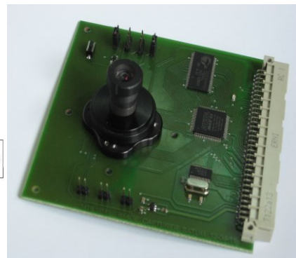
Figura 4.99. Modulul sistemului de captare imagini: a) schema PCB a modului; b) imaginea modului real.
