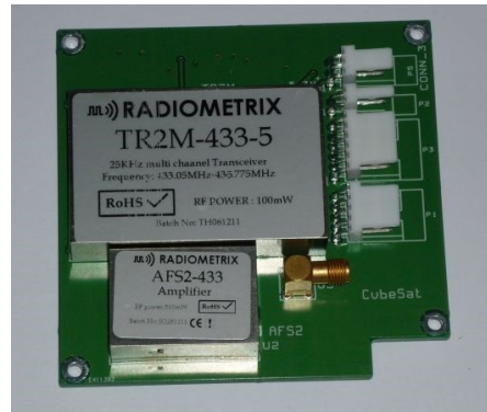
Figura 4.41. Prototipul modului RF cu transceiver tip TR2M Radiometric.
