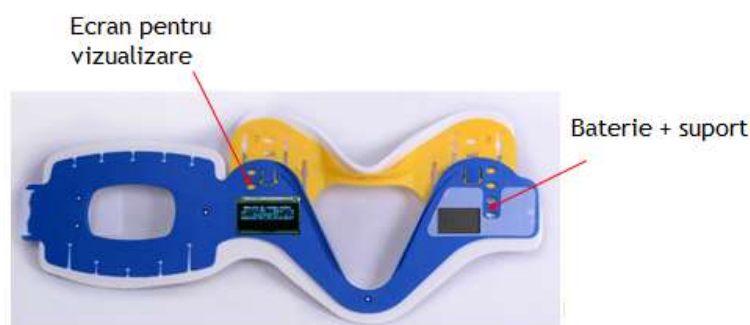
Figura 3. Vedere față externă a gulerului inteligent și amplasamentul ecranului de afișare parametri vitali
