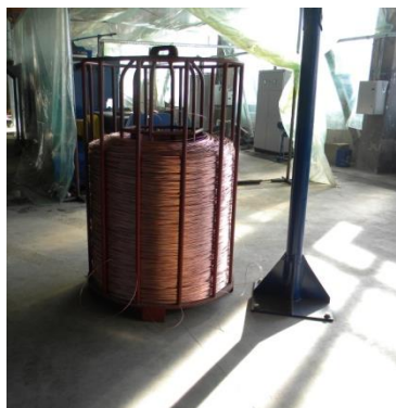
Figura 1.4. Fir de cupru pregătit pentru etapa a doua de trefilare
