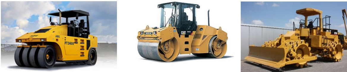
Figura 2.1. Exemple de utilaje care realizează compactarea prin acțiune statică asupra terenului
