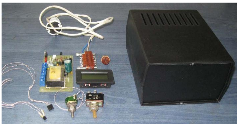
Figura 3 Montajul blocului de comandă
