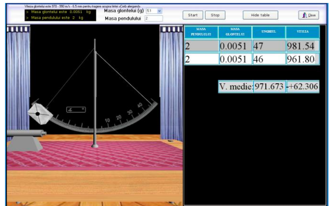
Fig. 2. Determinarea vitezei glonțului cu ajutorul pendulului balistic.
