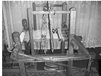
Fig. 6. Război de țesut manual realizat în baza instalațiilor de țesut populare de tip orizontal 34
