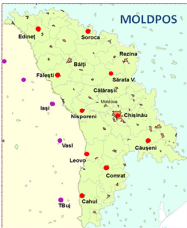
Fig. 1. Rețeaua de stații permanente GNSS pentru serviciul de poziționare MOLDDPOS
